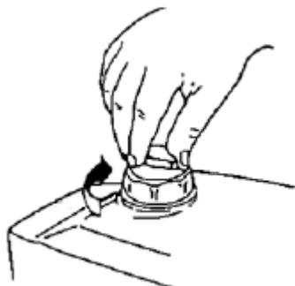
1. Закройте вентиляционный клапан топливного бака, закрутив его винт по часовой стрелке.
