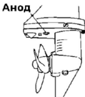
Подвесные лодочные моторы Gladiator защищаются от коррозии протекторными анодами. Периодически осматривайте наружные аноды, особенно если мотор эксплуатируется в морской воде. Удаляйте шелуху с поверхности анодов. Относительно замены анодов обращайтесь к дилеру моторов Gladiator.
