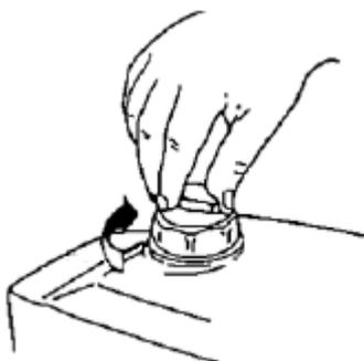
2. Закройте вентиляционный клапан топливного бака, закрутив его винт по часовой стрелке.
