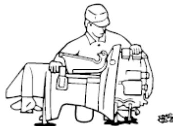
2. Выверните свечу зажигания и поставьте мотор свечным отверстием вниз, что бы дать стечь всей воде, илу, или грязи из внутренней полости двигателя.
