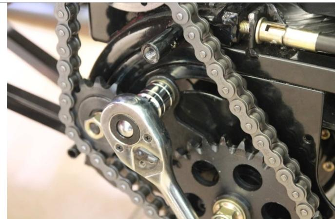
3.12.3. Зафиксируйте гайку натяжителя.
