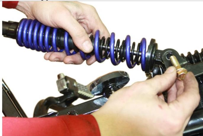
3.4.5. Фиксируем его с помощью болтов из комплекта. С другим рычагом проводим аналогичные действия.
