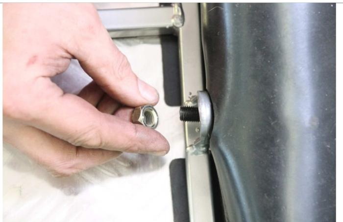
3.7.1. Устанавливаем прицепное устройство в технологическое отверстие.
