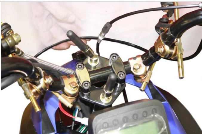
3.15.12. Устанавливаем лобовое стекло. Для этого пропускаем кронштейны, установленные на лобовом стекле, через малые хомуты.
