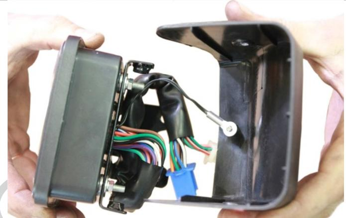
3.1.4. Снимаем декоративную крышку панели приборов.
