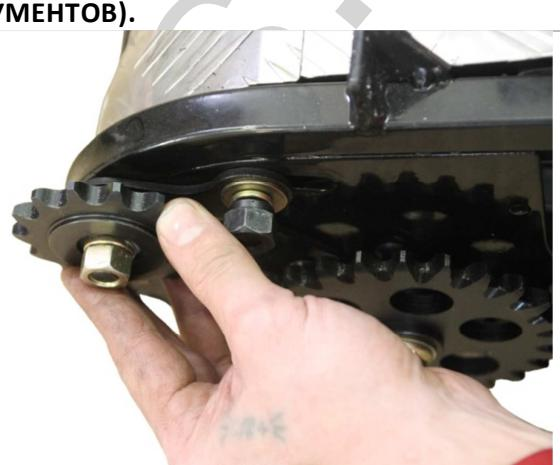
3.9.2. Переводим фиксатор в крайнее левое положение.
