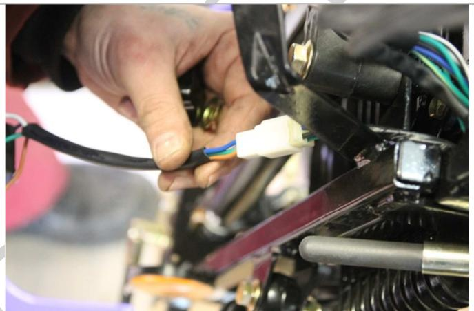
3.14.2. Подключаем разъём фары.
