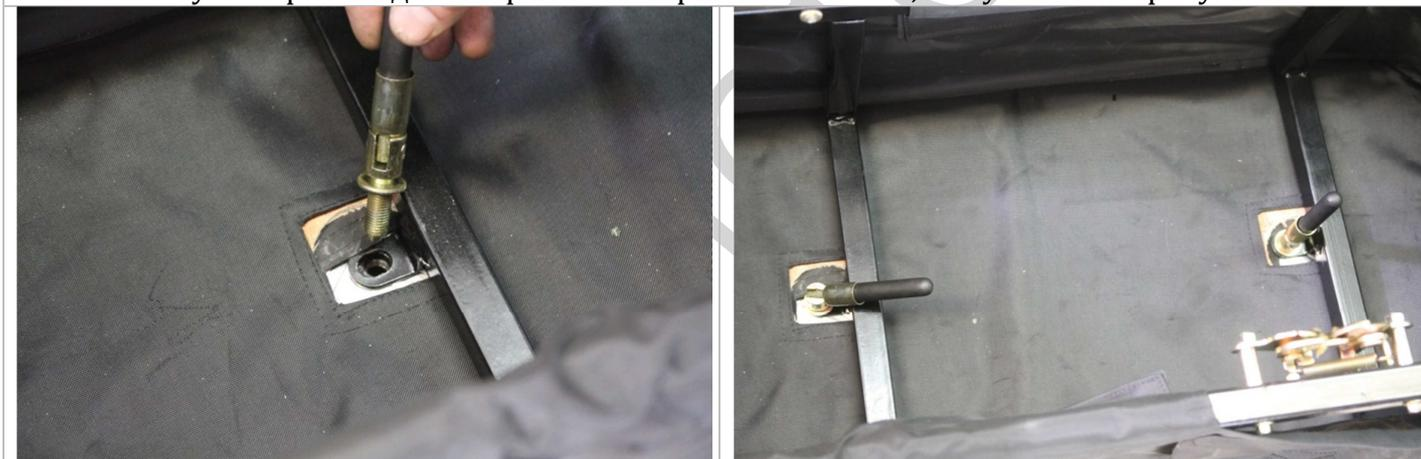
3.11.5. Фиксируем вело-болтами стойки сиденья на раме гусеничного блока. Полностью закручиваем болты только по окончании работ, описанных в пункте 3.14.8.
