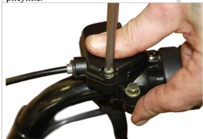
3.3.4. Устанавливаем крышку на место и закручиваем ранее выкрученные винты.
