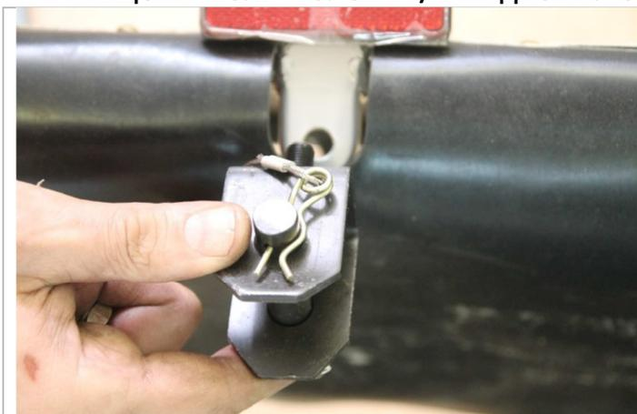
3.7.1. Устанавливаем прицепное устройство в технологическое отверстие.
