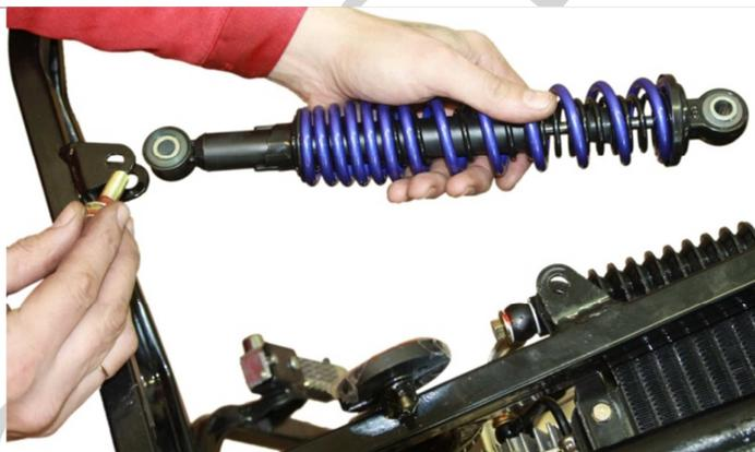
3.4.4. Устанавливаем амортизатор.
