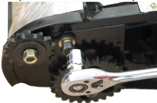
3.9.1. Откручиваем гайку фиксатора натяжителя резьбы.
