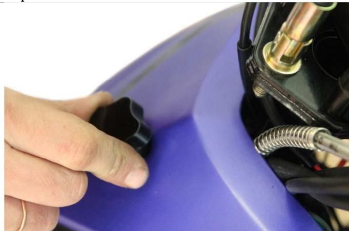
3.14.7. Закручиваем ранее выкрученный болт крепления пластика моторного блока (пункт 3.1.1.).
