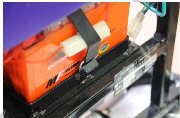
3.10.5. Фиксируем АКБ с помощью резинового фиксатора.
