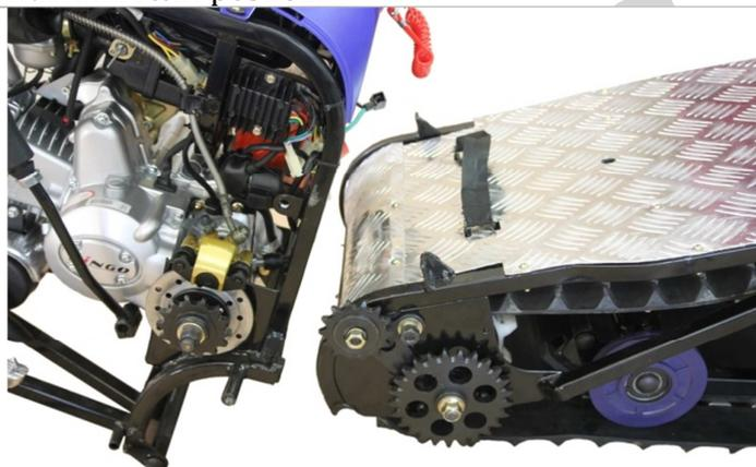
3.9.3. Устанавливаем блок двигателя и гусеничный блок друг напротив друга так, как указано на рисунке.
