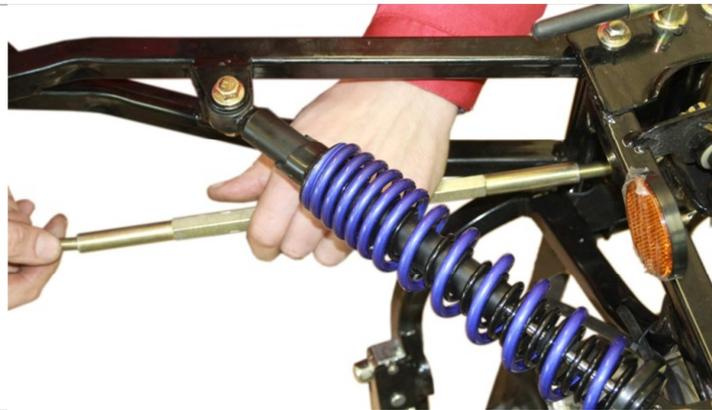
3.4.7. Устанавливаем рулевые тяги. Для этого совмещаем резьбу на рулевой тяге с резьбой на наконечниках рулевых тяг.
