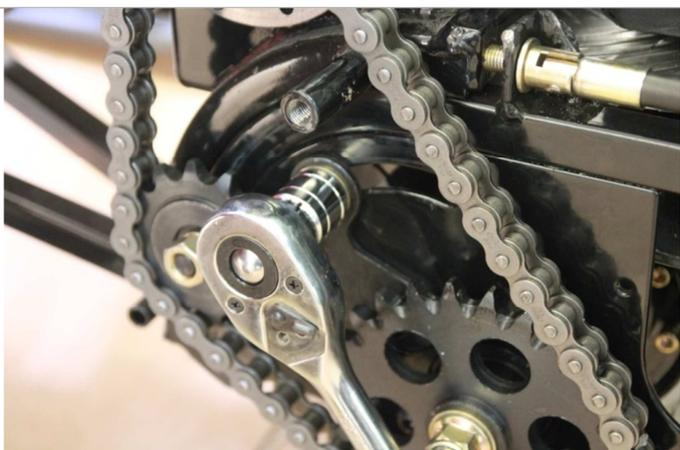
3.12.3. Зафиксируйте гайку натяжителя.
