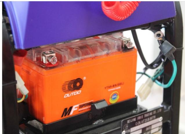
3.10.3. Снимаем с АКБ транспортировочную упаковку и устанавливаем АКБ в аккумуляторный отсек обратно.
