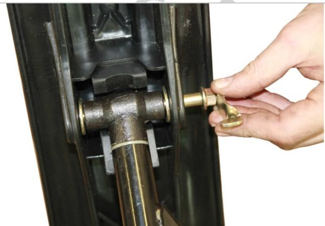
3.6.1. Соединяем вместе лыжу и рулевую стойку на рычаге.
