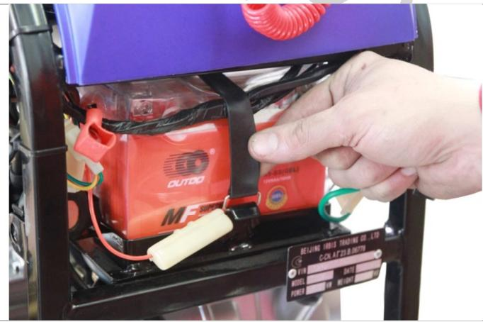
3.10.1. Снимаем резиновый фиксатор двигателя.
