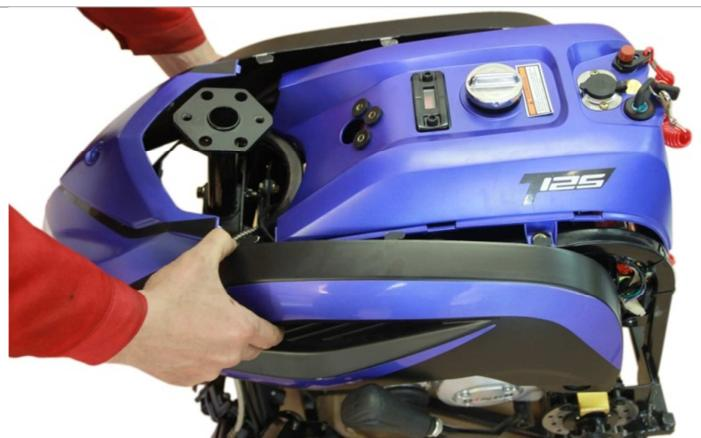
3.1.2. Снимаем пластик моторного блока.
