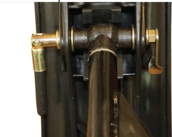
3.6.3. Фиксируем его с помощью болта и гайки из комплекта крепления лыж.
