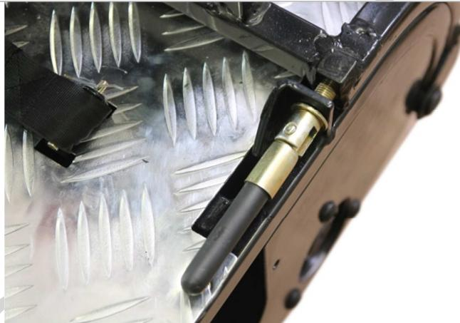
3.9.6. Фиксируем два блока вместе с помощью вело-болтов.
