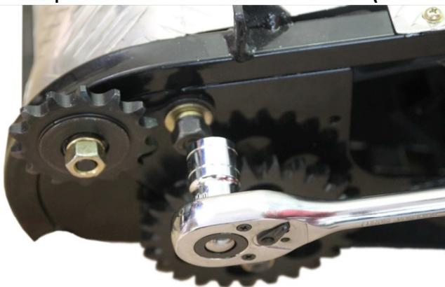
3.9.1. Откручиваем гайку фиксатора натяжителя резьбы.
