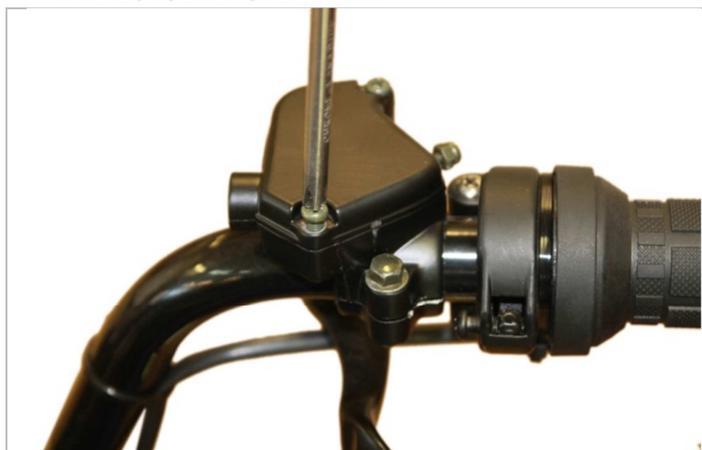
3.3.1. С помощью крестовой отвертки откручиваем два винта.
