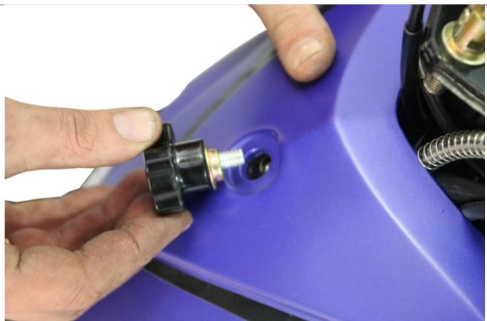
3.14.6. Закручиваем ранее выкрученный болт крепления пластика моторного блока (пункт 3.1.1.).
