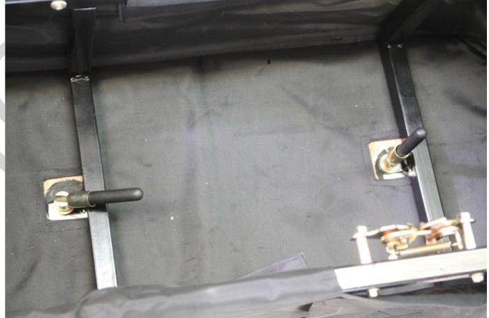
3.11.5. Фиксируем вело-болтами стойки сиденья на раме гусеничного блока. Полностью закручиваем болты только по окончании работ, описанных в пункте 3.14.8.
