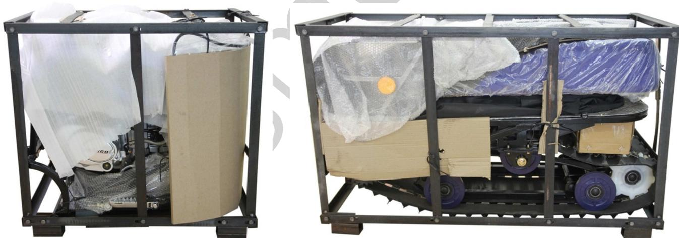
Снегоход поставляется в частично разобранном виде. Раскрутите болты металлического каркаса.
