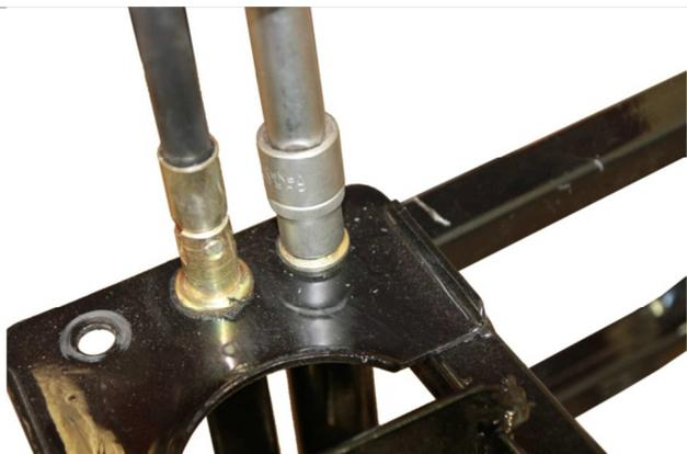
3.4.3. Закручиваем болт.
