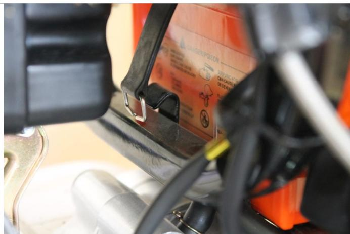
3.10.5. Фиксируем АКБ с помощью резинового фиксатора.
