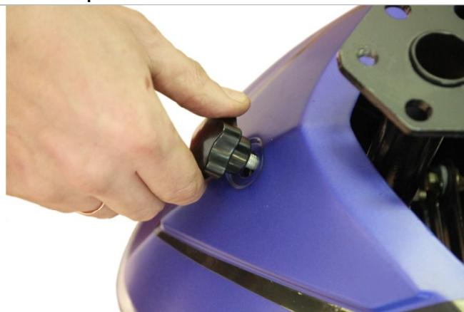
3.1.1. Откручиваем болт крепления пластика моторного блока.
