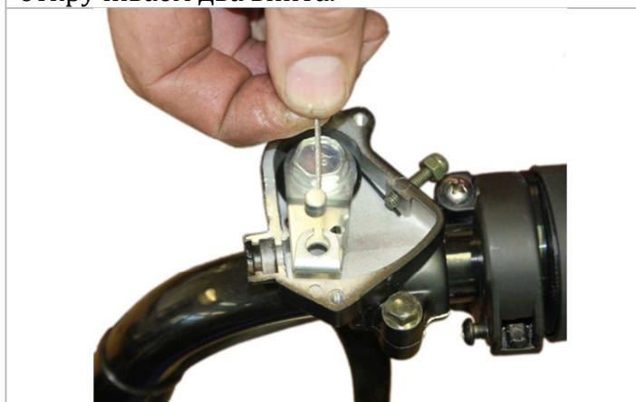
3.3.3. Фиксируем конец троса привода дроссельной заслонки заслонки так, как указано на рисунке.
