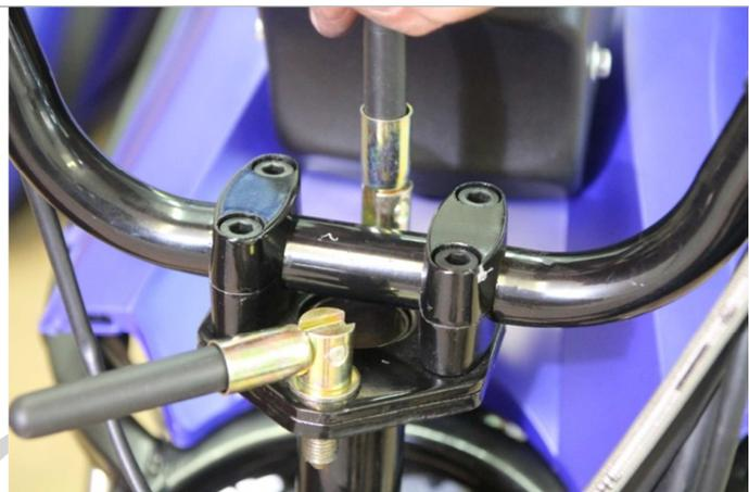
3.2.2. Закрепите руль с помощью вело-болтов из комплекта в двух точках крепления.
