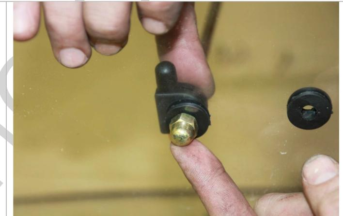
3.15.5. Прикручиваем кронштейн крепления лобового стекла к лобовому стеклу через ранее установленные прокладки так, как указано на рисунке.
