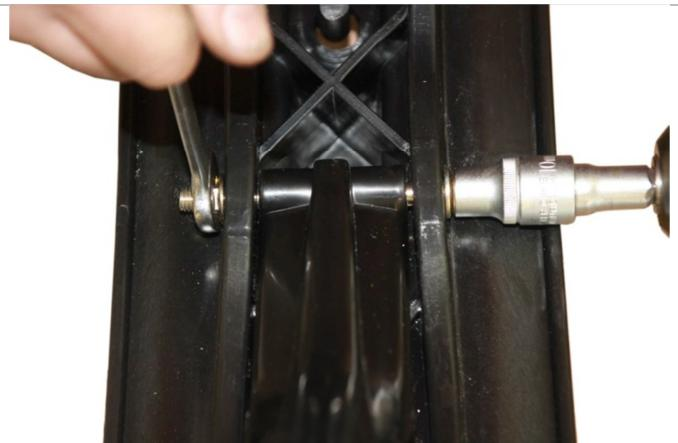
3.5.3. Навинчиваем гайку. С помощью инструмента затягиваем резьбовые соединения.
