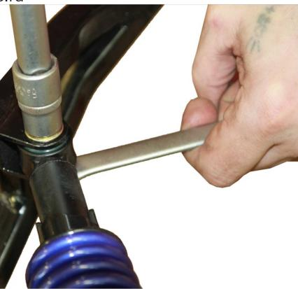
3.4.6. Закручиваем болты крепления амортизатора.
