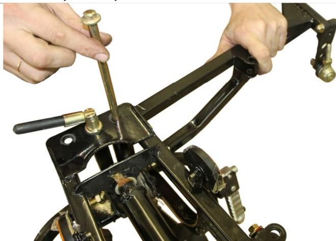
3.4.2. Устанавливаем рычаг передней подвески и фиксируем его с помощью болта из комплекта.
