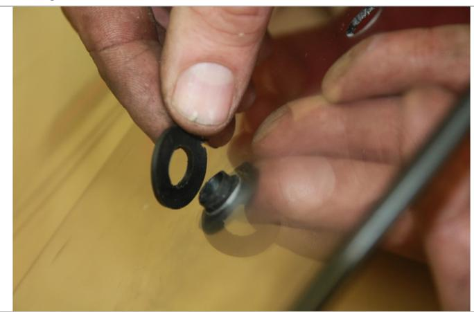
3.15.2. С внешней стороны стекла фиксируем ее с помощью прокладки, как указано на рисунке.
