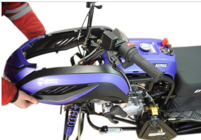
3.14.1. Устанавливаем ранее снятый передний пластик.
