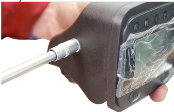
3.1.3. Откручиваем два винта крепления декоративной крышки панели приборов.
