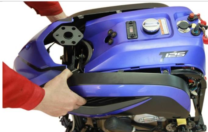
3.1.2. Снимаем пластик моторного блока.
