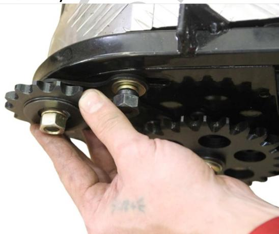
3.9.2. Переводим фиксатор в крайнее левое положение.
