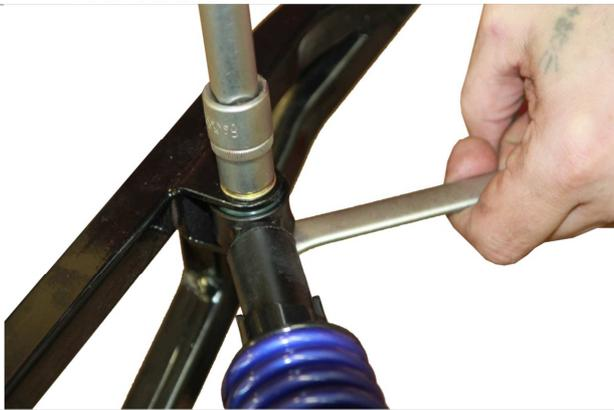
3.4.6. Закручиваем болты крепления амортизатора.
