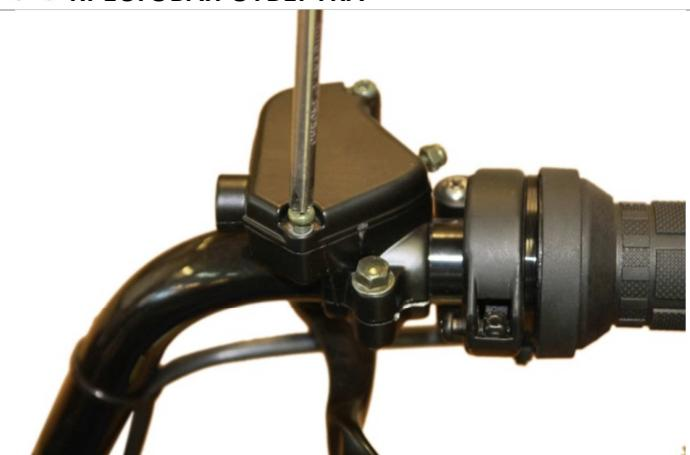
3.3.1. С помощью крестовой отвертки откручиваем два винта.
