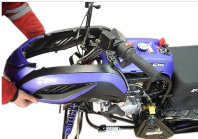
3.14.1. Устанавливаем ранее снятый передний пластик.
