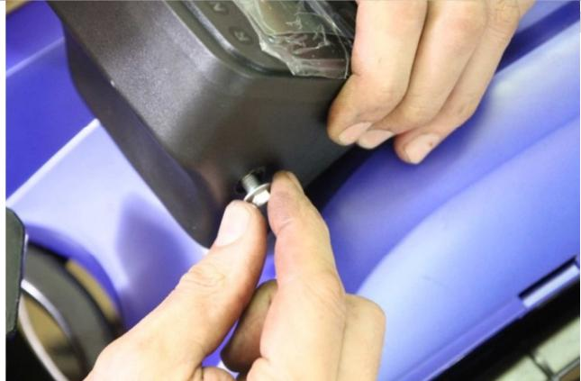
3.1.8. Одеваем декоративную крышку панели приборов.
