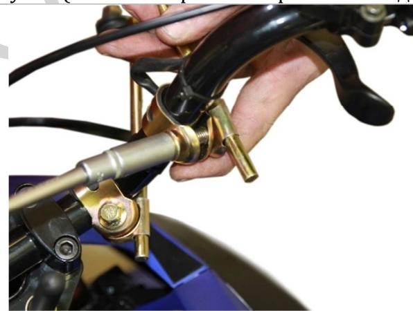
3.15.15. После того, как стекло установлено и выровнено, закручиваем все резьбовые соединения хомутов.
