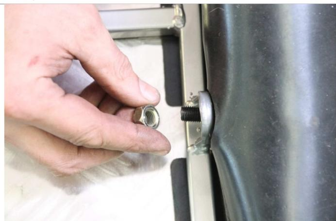
3.7.2. Фиксируем прицепное устройство с помощью гайки.
