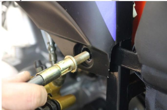
3.14.8. Закрепляем пластик и раму сиденья к раме моторного блока с левой и правой сторон снегохода. Для этого используем вело-болты из комплекта поставки. После этого докручиваем болты, указанные в пункте 3.11.5.
