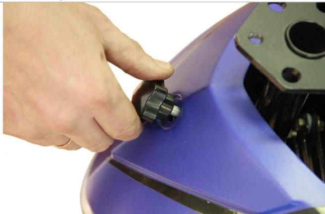
3.1.1. Откручиваем болт крепления пластика моторного блока.
