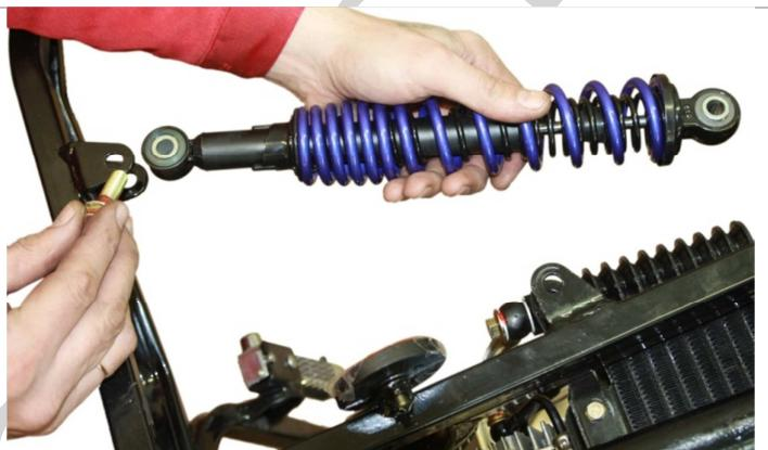
3.4.4. Устанавливаем амортизатор.
