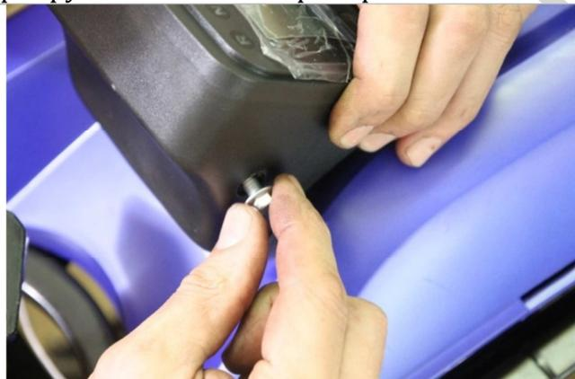
3.1.8. Одеваем декоративную крышку панели приборов.
