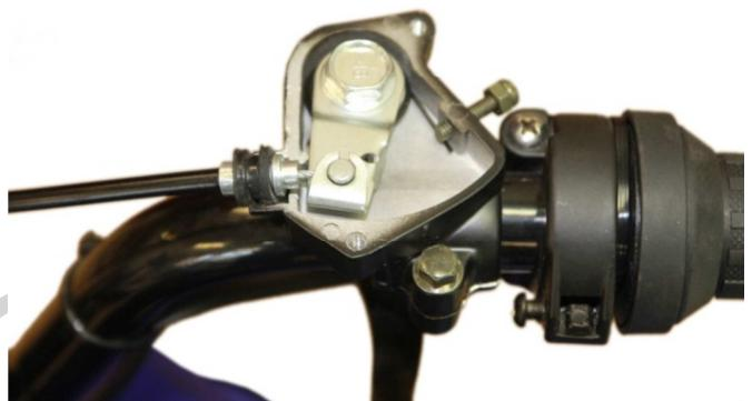
3.3.3. Фиксируем конец троса привода дроссельной заслонки заслонки так, как указано на рисунке.
