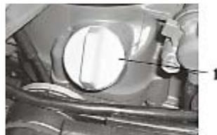
3. Замените прокладку под сливной винт и закрутите его.
