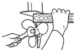
Выньте шплинт, отвинтите гайку против часовой стрелки, снимите винт.
