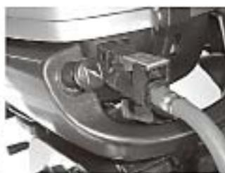
2. Переключите топливный кран на питание двигателя от соответствующего бака - внутреннего или внешнего, подключённого через коннектор.
