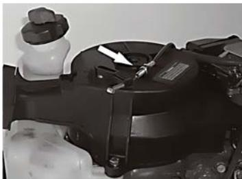
Открутите винты крепления, снимите защитный кожух и топливный бак.
