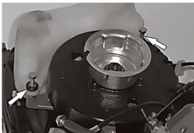
Снимите ручной стартер, замените шнур, поставьте стартер на место.
