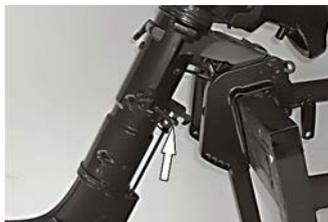
На воде это положение удобно для проверки состояния винта.
