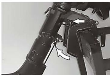
Чтобы опустить двигатель вниз слегка наклоните его внутрь лодки, отведите рычаг фиксатора и медленно опускайте мотор.
