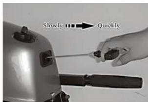
6. После запуска двигателя плавно верните ручной стартер в исходное состояние.
