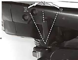
**Внимание. Запуск двигателя при положении передачи не «нейтраль» приведёт к моментальному началу движения лодки и возможной аварийной ситуации!**
