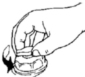
При работе лодочного мотора от встроенного топливного бака, клапан необходимо открыть (отвернуть против часовой стрелки) на 2 – 3 оборота, что бы обеспечить поступление воздуха в топливный бак.
