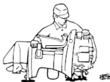
3. Выверните свечу зажигания и поставьте мотор свечным отверстием вниз, что бы дать стечь всей воде, илу, или грязи из цилиндра двигателя.
