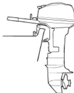
Подвесной мотор, закрепленный на транце лодки, должен транспортироваться в нормальном рабочем положении.
