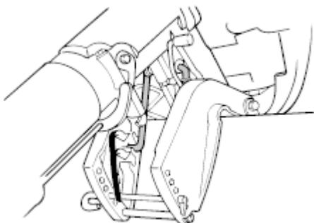
2. Приподнимайте мотор, пока не услышите, как упор для поддержания мотора вошел в фиксатор соответствующий движению по мелководью.
