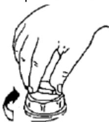
Вентиляционный клапан находится на крышке топливного бака. При хранении или переноске мотора с места на место клапан должен быть закрыт (завернут по часовой стрелке), чтобы исключить подтеки топлива из бака.
