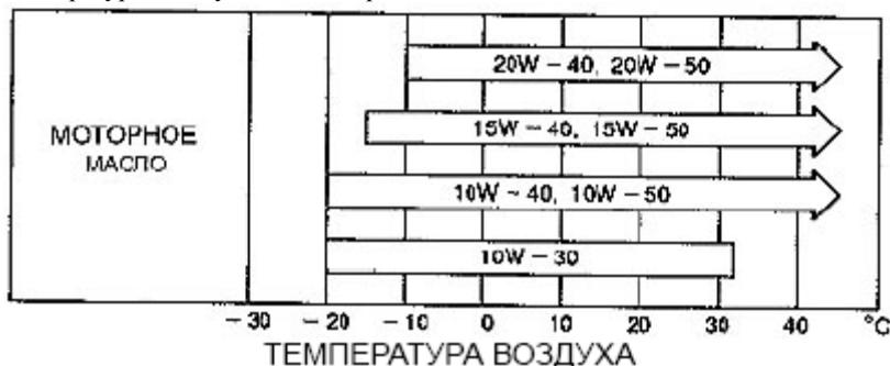
**Примечание:** Использование не отвечающего вышеприведенным требованиям масла приводит к быстрому износу мотора, трудностям с его запуском и т.п.
