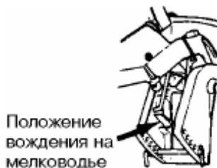
Чтобы вернуть мотор в исходное положение, необходимо поднять мотор до упора, затем медленно опустите в нормальное положение.
