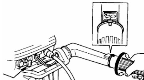
6. Вытянуть рычаг подсоса (когда мотор прогрелся, подсос не нужен).
