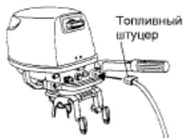
3. Грушей подкачивать в карбюратор топливо, пока она не станет тугой. Если мотор оснащён встроенным баком, то для заполнения карбюратора самотёком может потребоваться 1-2 минуты.
