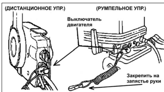
обязательно закрепляйте его на запястье, или зафиксируйте на одежде и не снимайте до остановки двигателя.
