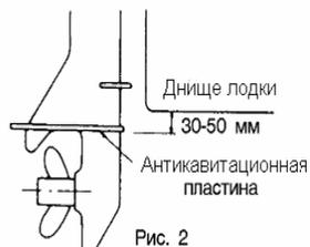
3. Прикрепить мотор к лодке, затянуть ручную винты. Для страховки привязать мотор верёвкой к лодке.
