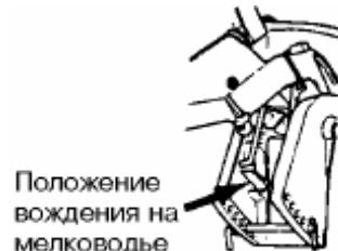
Чтобы вернуть мотор в исходное положение, необходимо поднять мотор до упора, затем медленно опустите в нормальное положение.
