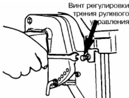
**Примечание:** не использовать регулировку трения в качестве фиксатора. Это может вызвать повреждения вертлюжной скобы.
